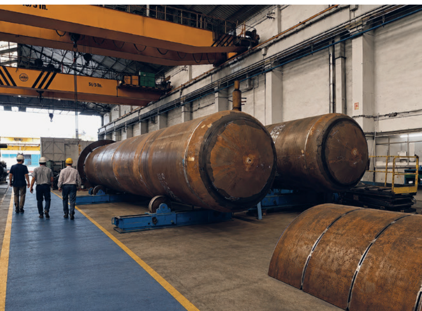
Beim Unternehmen Lointek werden die Dampferzeuger für die Natrium-Anlage von TerraPower gefertigt. Sie übertragen die Wärme vom sekundären Natriumkreislauf auf den Wasser-Dampf-Kreislauf zur Stromerzeugung. (Foto: TerraPower via LinkedIn)
