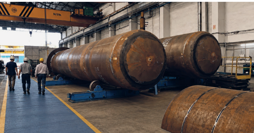
C'est chez Lointek que sont fabriqués les générateurs de vapeur destinés à la centrale «Natrium» de TerraPower. Ils transfèrent la chaleur du circuit secondaire au sodium vers le circuit eau-vapeur servant à la production d'électricité. (Photo: TerraPower via LinkedIn)
