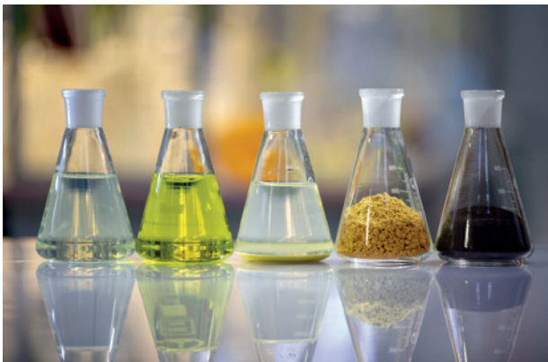
Différents échantillons d'uranium provenant du Kazakhstan. La matière solide jaune, connue sous le nom de yellowcake ( U_3O_8 ), est transformée en plusieurs étapes en combustible pour les centrales nucléaires. (Photo: Kasatomprom)
