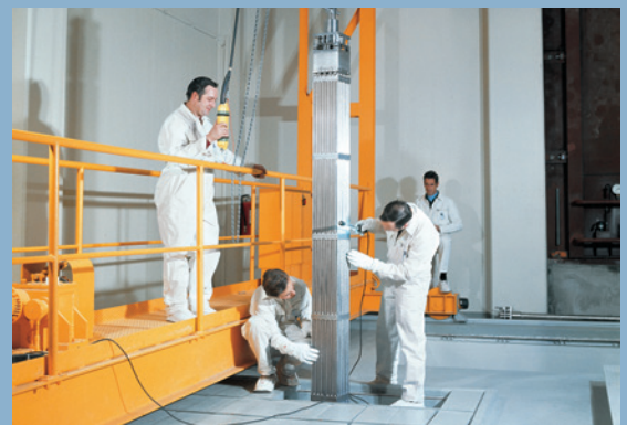
Handhabung eines frischen Brennelements. Frischer Uran-Kernbrennstoff benötigt aufgrund seiner hohen Energiedichte nur wenig Lagerraum. (Foto: Axpo)
