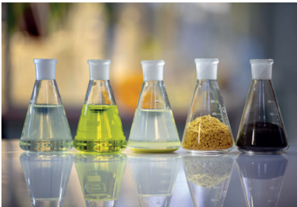
Verschiedene Uranproben aus Kasachstan. Der gelbe Feststoff ist als Yellowcake ( U_3O_8 ) bekannt und wird in mehreren Schritten zu Brennstoff für Kernkraftwerke weiterverarbeitet. (Foto: Kasatomprom)
