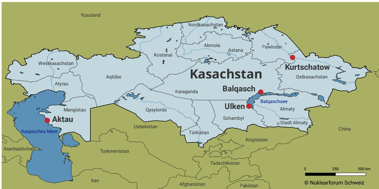
Karte von Kasachstan mit den vier Standorten, die für ein Kernkraftwerk diskutiert wurden. Das erste Kernkraftwerk des Landes vom russischen Typ WWER-1200 soll beim Dorf Ulken gebaut werden. Ein zweites Kernkraftwerk vom chinesischen Typ Hualong One ist voraussichtlich an den Standorten Kurtschatow oder Balqasch geplant. Aktau steht ebenfalls zur Diskussion für eine Anlage. An einem dieser Orte könnte vermutlich das dritte Kernkraftwerk des Landes errichtet werden.
