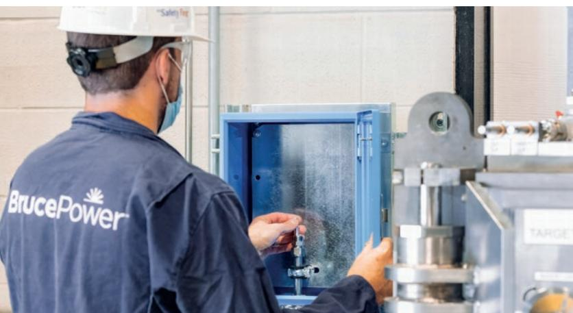
Production du radionucléide Lutetium 177 dans la tranche 7 de la centrale nucléaire canadienne de Bruce, un réacteur à eau lourde de type Candu. Pendant le fonctionnement de ce dernier, un employé introduit une cible dans le système de production d'isotopes (IPS) afin d'irradier de l'ytterbium 176 dans le cœur du réacteur et d'obtenir du lutétium 177. (Photo: Bruce Power)
