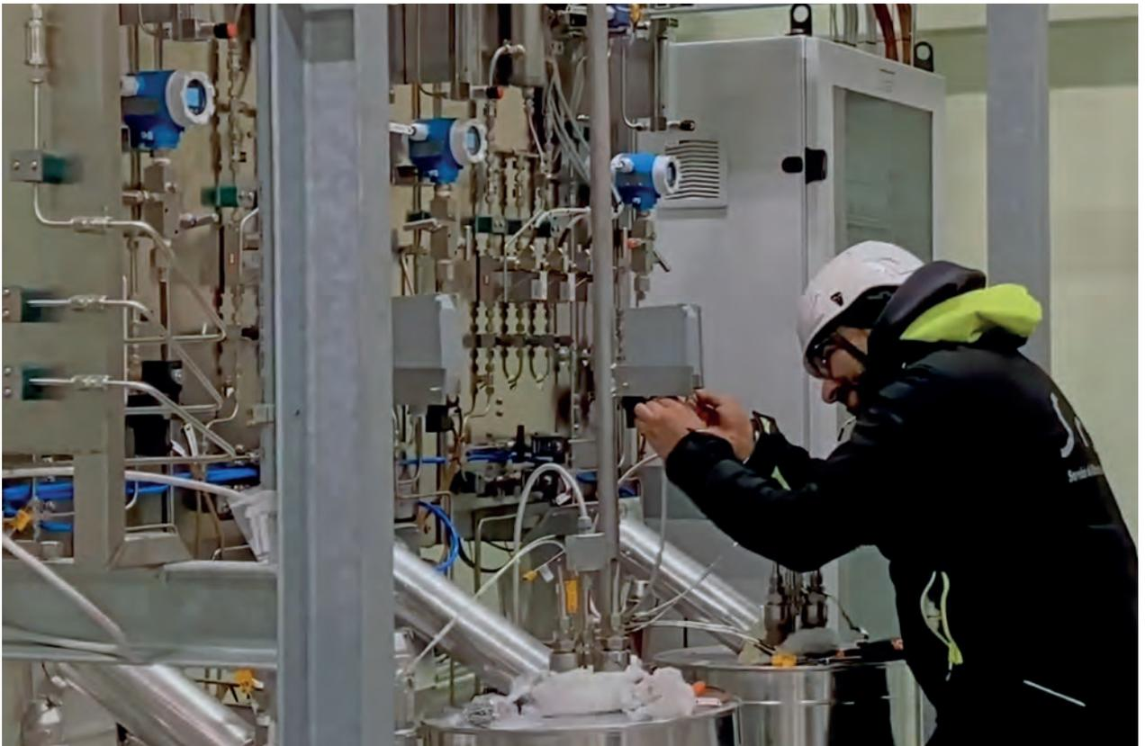
L'installation dernier cri «CAPSULE» est utilisée pour tester la résistance à la corrosion des matériaux dans le plomb. Elle est équipée d'un contrôle avancé de la température et du taux d'oxygène. (Photo: Newcleo via LinkedIn)
