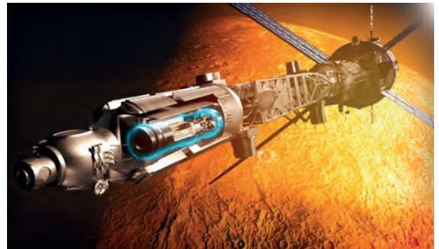
Rakete mit Nuklearantrieb auf Basis eines Mikroreaktors. (Foto: Rolls-Royce)
