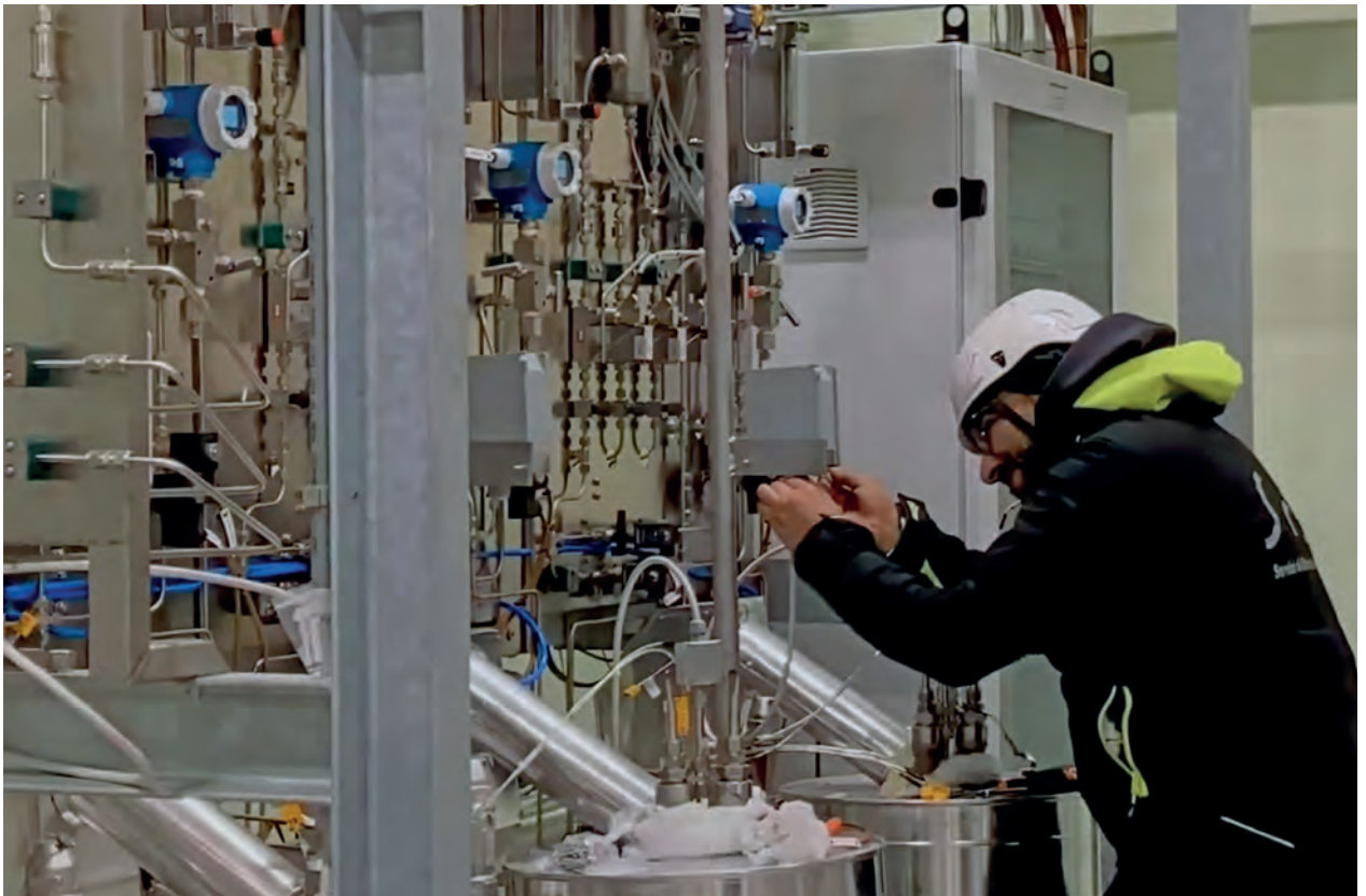
Die hochmoderne Anlage «CAPSULE» dient Korrosionstests von Materialien in stehendem Blei und besitzt eine fortschrittliche Temperatur- und Sauerstoffgehaltskontrolle. (Foto: Newcleo via LinkedIn)
