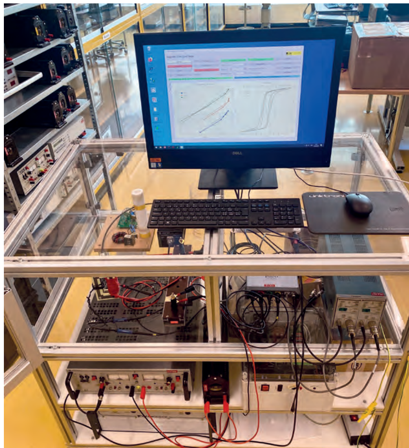
Le banc d'essai pour la mesure des propriétés des matériaux magnétiques doux en électrotechnique: Sur l'écran sont représentées à droite les courbes d'hystérésis magnétiques d'un noyau de fer, à gauche les puissances dissipées calculées à partir de ces courbes. Dans la partie inférieure du banc d'essai se trouvent l'objet à tester, les amplificateurs moyenne et haute fréquence, ainsi que l'électronique de mesure. (Photo: Institut für Elektrische Energietechnik de la FHNW)
