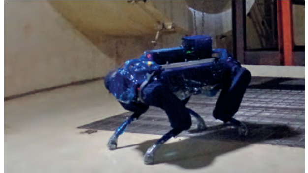
Pour la première fois, KHNP utilise un robot autonome dans le cadre de travaux de démontage et de décontamination de la tranche nucléaire Kori 1. (Photo: KHNP)
