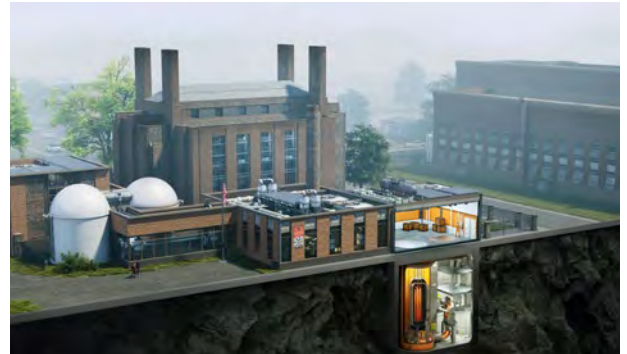
Le microréacteur modulaire du développeur américain USNC est un réacteur haute température refroidi au gaz de la génération IV. Il sera construit dans le sous-sol. (Photo: USNC)
