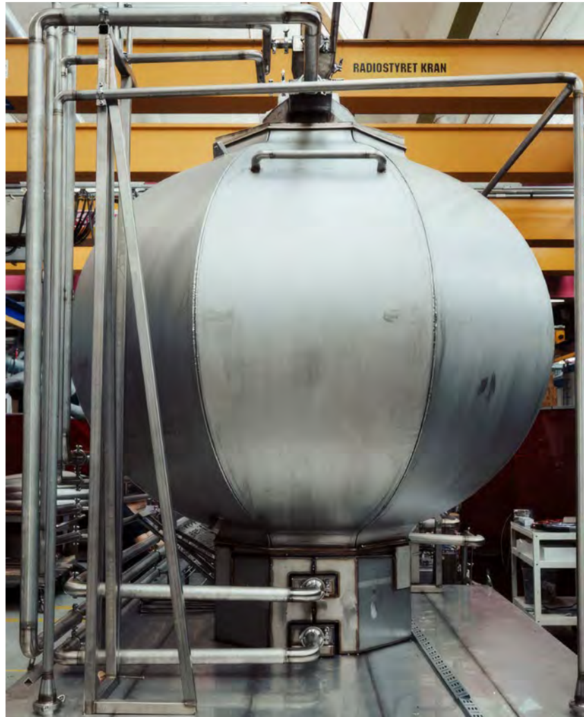
Copenhagen Atomics a baptisé «Onion Core» le cœur breveté de son réacteur par référence à sa forme et à sa structure.
