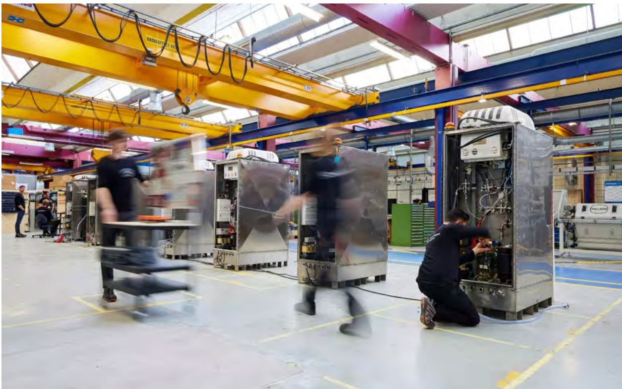
Copenhagen Atomic's fabrique des circuits à sels fondus pour ses propres tests de matériaux, mais aussi pour les vendre et générer ainsi des revenus. (Photo: Copenhagen Atomic's)
