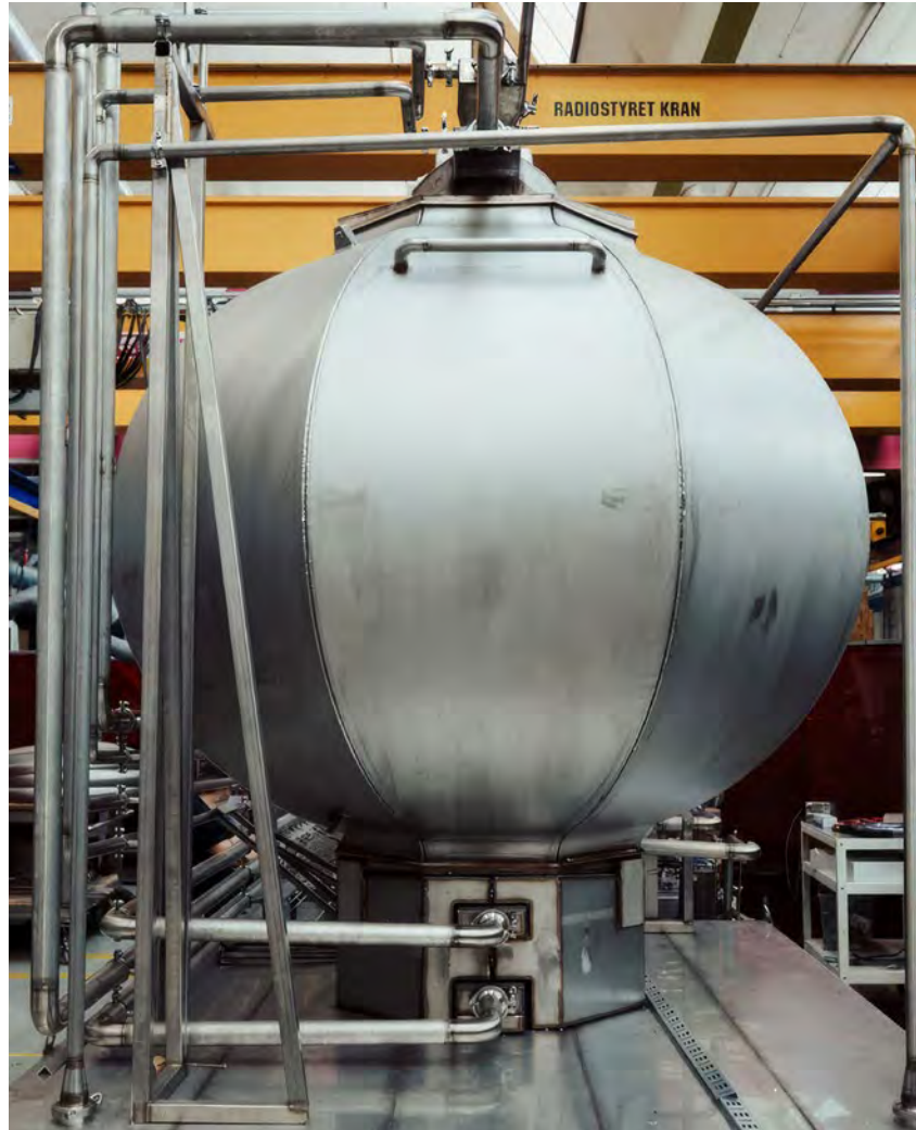
Copenhagen Atomics nennt seinen patentierten Reaktorkern «Onion Core» und bezieht sich damit auf dessen Form und Aufbau einer Zwiebel. (Foto: Copenhagen Atomics)
