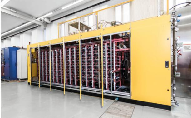
Eine der Haupt-Hochspannungs-Gleichstromversorgungen (main high voltage DC power supplies) die Ampegon für das Fusionsprojekt des Internationalen Thermonuklearen Experimentalreaktors (Iter) in Südfrankreich hergestellt hat. (Foto: Ampegon Power Electronics)
