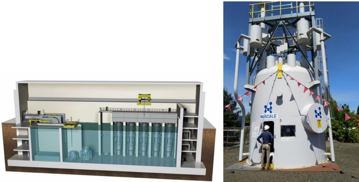
Abb. 2-5: Illustrationen des SMR VOYGR von NuScale. Links: Querschnitt (Quelle: NuScale), rechts: massstabgetreues Modell (Quelle: Lukas Robers)
