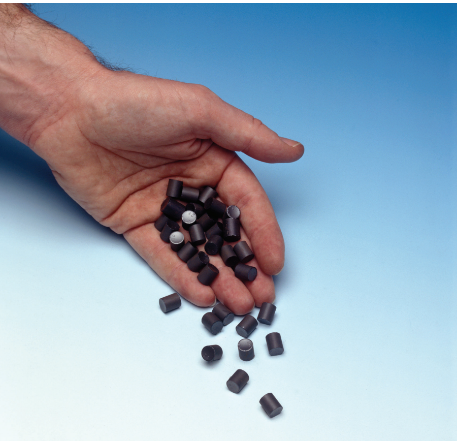
▲ Combustible d'uranium sous la forme sous laquelle il est utilisé dans les centrales nucléaires. Trois ou quatre de ces pastilles d'oxyde d'uranium ( UO_2 ) permettent de couvrir la consommation d'électricité d'un ménage de quatre personnes pendant un an. Photo: KKG
