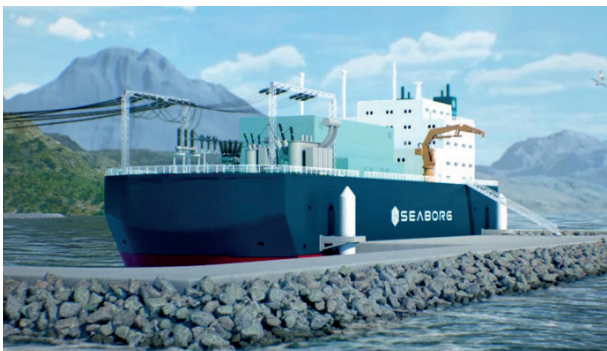
Représentation générée par ordinateur de la centrale nucléaire flottante CMSR Power Barge de Seaborg. (Photo: Seaborg)
