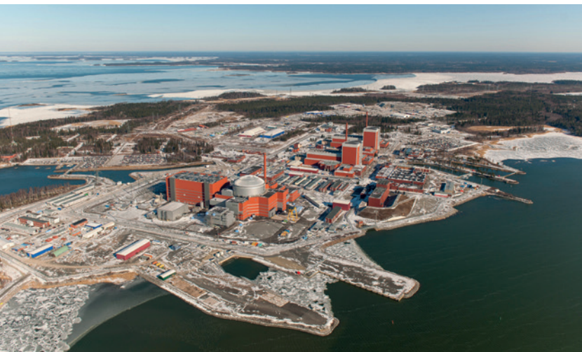
Am Standort Olkiluoto auf der gleichnamigen Insel an der Westküste Finnlands sind zwei Siedewasserreaktoreinheiten und ein EPR in Betrieb. Letztmals wurde vor über 40 Jahren eine Kernkraftwerkseinheit in Finnland in Betrieb genommen. (Foto: TVO)
