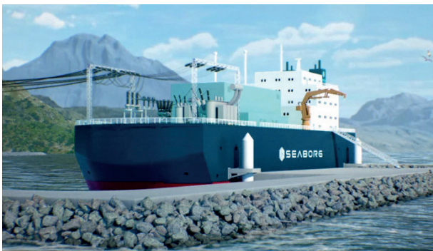
Computergenerierte Darstellung des schwimmenden Kernkraftwerks CMSR Power Barge von Seaborg. (Foto: Seaborg)
