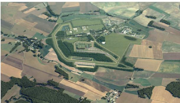
Das geologische Tiefenlager Cigéo besteht aus Anlagen an der Erdoberfläche und unter dem Erdboden. Die fotorealistische Darstellung zeigt eine der Oberflächenanlagen, in der die Abfälle angeliefert, zur Endlagerung vorbereitet und in die Tiefe transportiert werden. (Foto: Andra)
