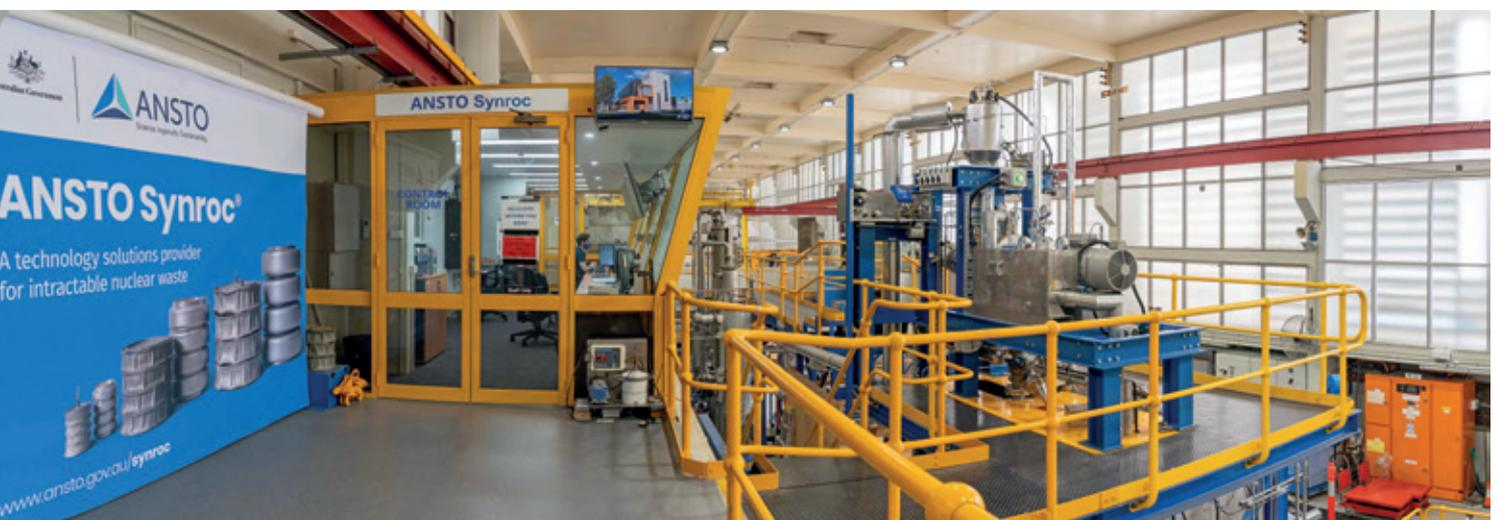
Coup d'œil à l'intérieur de l'installation de démonstration Synroc d'Ansto. La forme de déchets Synroc destinée au stockage final (boîtes en acier à gauche de l'image) est fabriquée par pressage isostatique à chaud. (Photo: Ansto)
