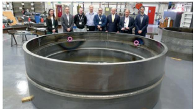
Les segments d'acier ronds soudés entre eux au moyen de la technique du soudage par faisceau d'électrons, par l'entreprise Sheffield Forgemasters. (Photo: Sheffield Forgemasters)
