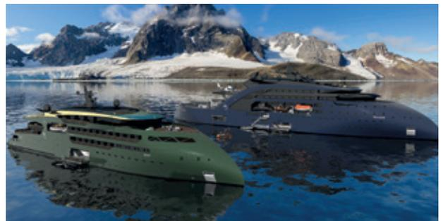
Le concept du chantier naval norvégien d'Ulstein prévoit que jusqu'à quatre navires de croisière fonctionnant avec des batteries, comme le SIF (en vert), pourront être rechargés en électricité simultanément grâce à un RSF au thorium placé à bord du navire de ravitaillement Thor (en bleu). (Photo: Ulstein)
