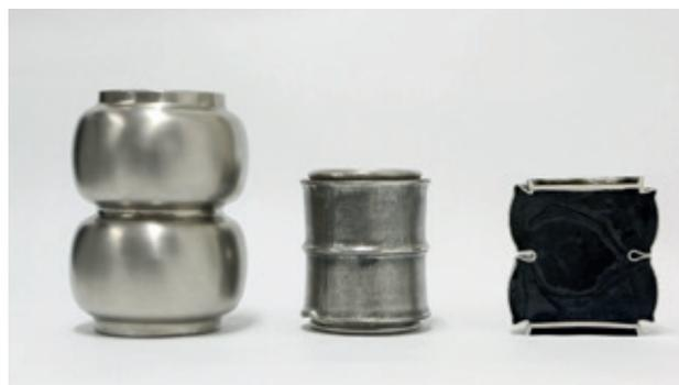
La boîte en acier à gauche est remplie des composants du Synroc et des déchets radioactifs qui doivent être stockés. La boîte est comprimée sous l'effet du pressage isostatique à chaud (au centre de l'image) et on obtient une céramique extrêmement dense. Le dessin à droite correspond à la roche synthétique Synroc (noire) présente dans la boîte comprimée. (Photo: Ansto)
