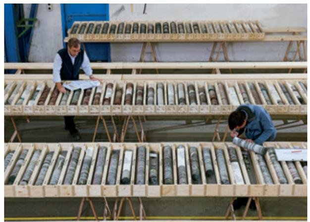
Die Nagra hat über 6000 Meter Bohrkerne aus der Tiefe geholt. Alle diese Gesteinsproben hat sie in einer Halle in Holzboxen ausgelegt und von zahlreichen Experten begutachten lassen. (Foto: Nagra)
