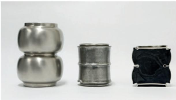
Die Edelstahl-dose links im Bild wird mit den Bestandteilen von Synroc und dem zu entsorgenden radioaktiven Abfall gefüllt. Durch heissisostatisches Pressen wird die Dose zusammengepresst (mittleres Bild) und eine extrem dichte Keramik erhalten. Dieses synthetische Synroc-Gestein ist in der gepressten, aufgeschnittenen Dose als schwarzer Inhalt sichtbar (rechtes Bild). (Foto: Ansto)
