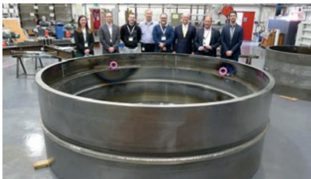
Die von Sheffield Forgemasters mittels Elektronenstrahlschweissen miteinander verbundenen runden Stahlsegmente. (Foto: Sheffield Forgemasters)
