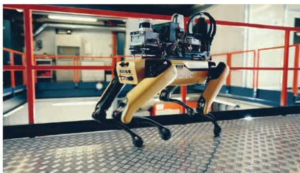
Strahlenschutz mit Hightech: Der Roboter Spot geht für Menschen in Bereiche mit hoher Dosisleistung. (Foto: Apxo)
