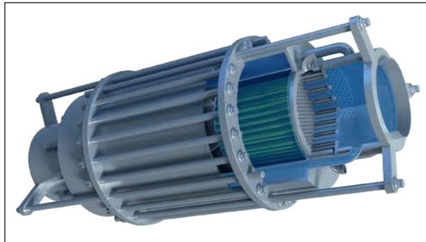
Der Kern des Dual-Fluid-Reaktors im Modell. (Foto: Dual Fluid)
