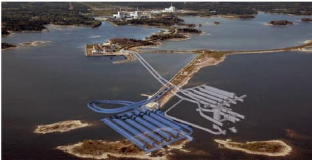
Die geplante Erweiterung (in blau) des geologischen Tiefenlagers für schwach- und mittelaktive Abfälle in Forsmark – SFR – umfasst sechs neue Felskavernen. (Foto: SKB)
