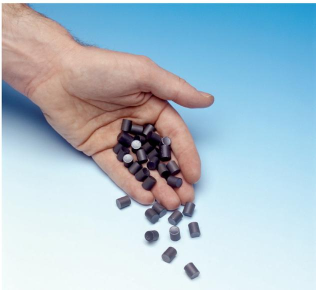
Le combustible d'uranium sous sa forme d'utilisation dans les centrales nucléaires. Deux de ces pastilles d'uranium (UO<sub>2</sub>) permettent de couvrir la consommation d'électricité d'un ménage de quatre personnes pendant un an.
